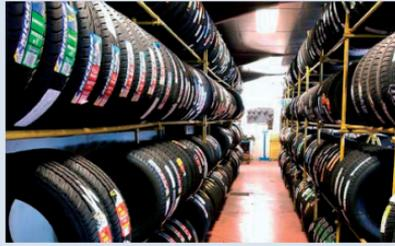
Se sono montati sul cerchio, gli pneumatici devono preferibilmente essere stoccati gonfiati, in posizione verticale, o in una sola fila su scaffali. Possono anche essere posizionati in orizzontale, ma l'altezza delle pile dovrà essere limitata, ad evitare problemi di instabilità.
